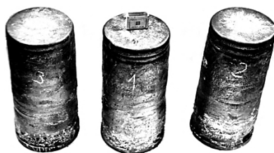
Рис. 1. Внешний вид электрошлаковых слитков из стали 40
